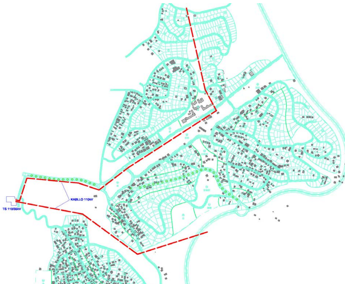
Fig.27 Trasa e kablos 110kV
