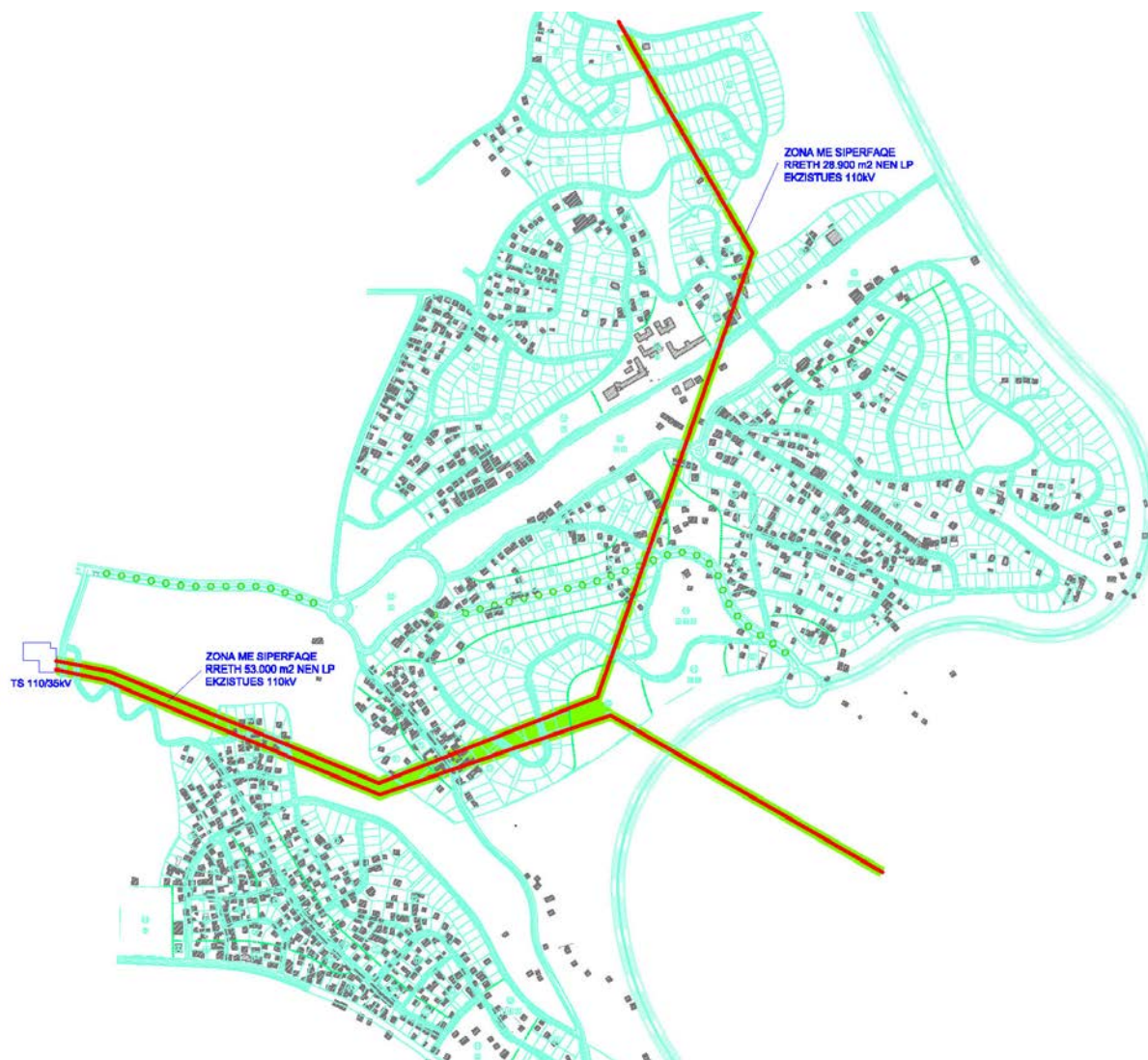
Fig.26 Trasa e largëpërçuesit ekzistues 110kV në shtylla metalike
